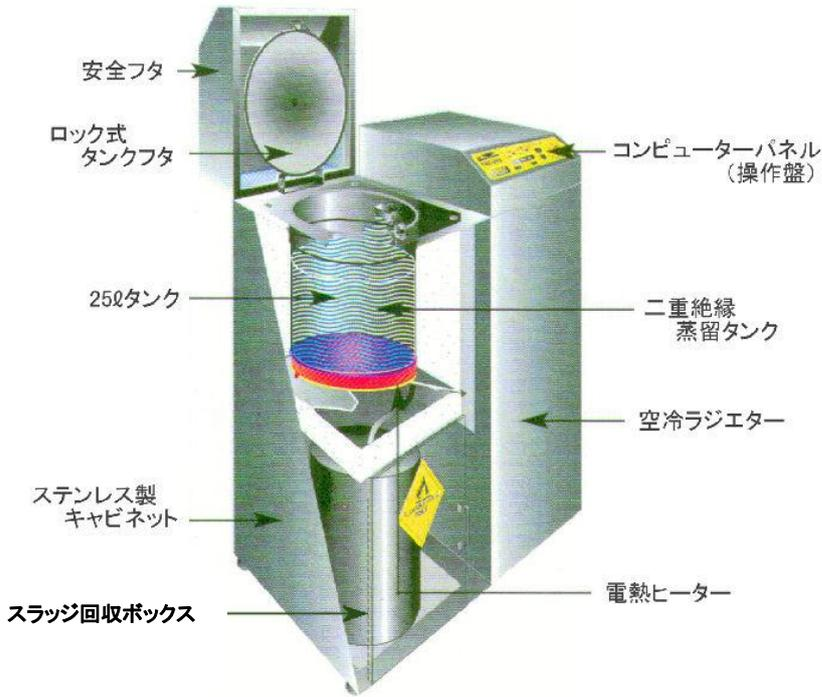
二重絶縁蒸留タンク内に溜まった廃液は電熱ヒーター（単相 200V）で加熱され、液晶表示パネルに加熱中であることが表示されます。廃溶剤の場合、加熱後約 15～60 分でタンク内の廃液が沸騰し始め、蒸気がタンク内の蒸気取入口より、コンデンサーパイプの中に入ります。自動強制空冷ファンにより、パイプ内の蒸気が冷却され、液体となり、回収缶にきれいな常温のシンナー、洗浄剤等が溜まり始めます。この作業が繰り返される事により再生が完了します。また、すべての機種に自動運転・自動停止機能が装備されています。これはマイコン制御により、蒸留タンク及びコンデンサーパイプの温度コントロールが自動的に行われ、強制空冷ファンの停止で安全性が確認された後、運転が自動停止いたします。
